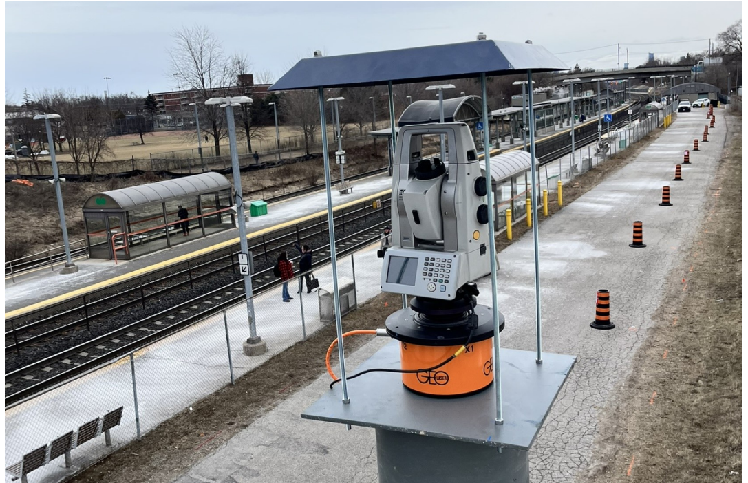
AMTS sur tribrach à nivellement automatique
